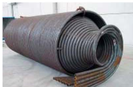
Змеевик парогенератора мод. GMT двойной спирально-навитый змеевик, выполненный из жаропрочной стали с минимальным количеством сварных соединений; опрессовывается на заводе-изготовителе азотом.
