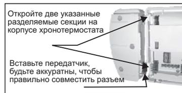
Откройте две указанные разделяемые секции на корпусе хронотермостата
