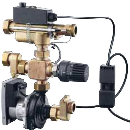
Насосно-смесительный блок Oventrop Regifloor HN для комбинированных систем радиаторного и напольного отопления. Включает энергоэффективный насос с частотным управлением, смесительный узел с трёхходовым клапаном и терморегулятором с накладным датчиком, а также температурное реле отключения насоса для защиты тёплого пола от перегрева
