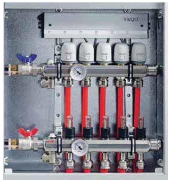
Коллекторный узел Viega с нержавеющей коллекторами с термометрами, воздухоотводчиками и сливными кранами, с расходомерами на подающих отводах и клапанами — на обратных. Сервоприводы на клапанах обратного коллектора подключены к управляющему модулю
