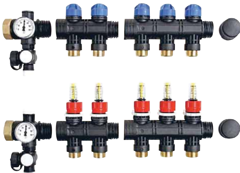
Модульная конструкция пластиковых коллекторов Тесе позволяет собирать коллекторы с любым количеством отводов, соединяя элементы с 2, 3 или 4 отводами на каждом. Отводы на подающем коллекторе оснащены расходомерами, на обратном — встраиваемыми клапанами. Коллекторы могут быть дополнены узлами подключения с термометрами и сливными кранами
