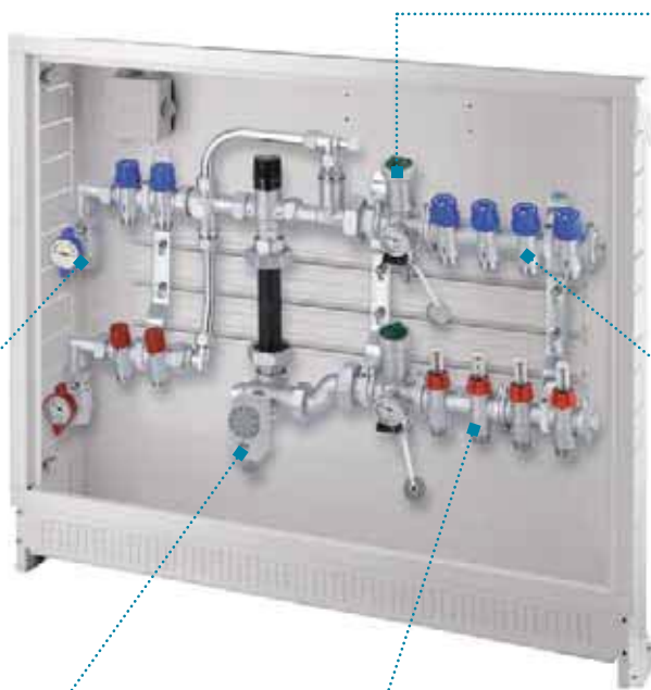
Конструкция узла с использованием насосно-смесительного блока и байпаса с крестовиной позволяет одновременно функционировать двум контурам отопления — высокотемпературному радиаторному и низкотемпературному контуру тёплого пола
