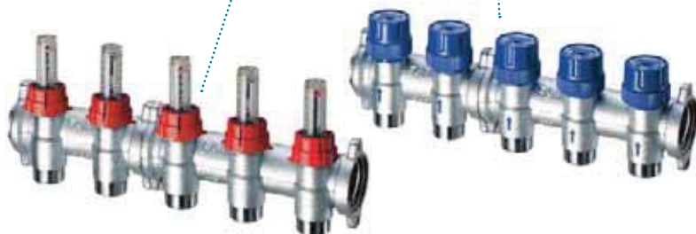
Латунные фланцевые коллекторы FAR состоят из собранных вместе блоков по два или три отвода. Герметичность соединений между блоками обеспечивает уплотнение O-Ring. На подающем коллекторе — расходомеры, на обратном — терморегулирующие клапаны
