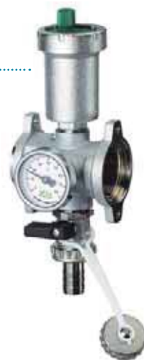
Промежуточный узел FAR оборудован биметаллическим термометром со шкалой от 0 до 80 °С, отображающим температуру линии, автоматическим воздухоотводчиком и сливным краном со штуцером
