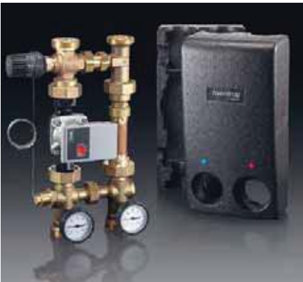
Насосная группа Oventrop RTA для обвязки твердотопливных котлов. Она оснащена смесительным узлом с механическим термостатом для поддержания заданной температуры теплоносителя обратной линии и позволяет быстро прогнать котёл при старте и уменьшить образование конденсата
